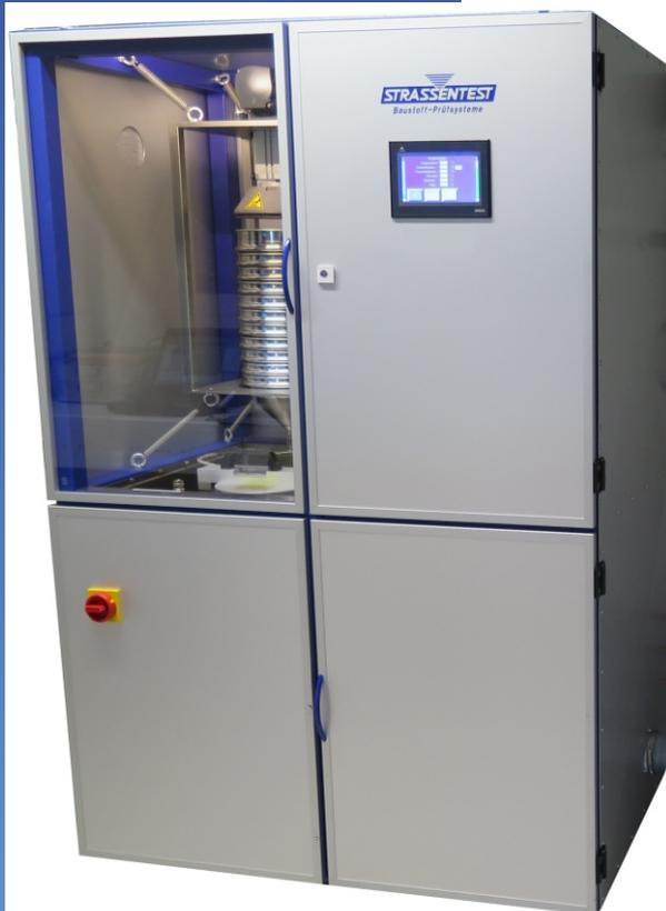
Der automatische Asphaltanalysator A01140 arbeitet nahezu ohne Lösungsmittelverlust und berücksichtigt somit die Belange des Personen- wie des Umweltschutzes (BimSchV).
